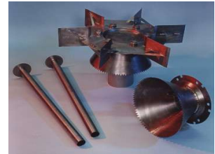
Turbine mit Einleitrohren
