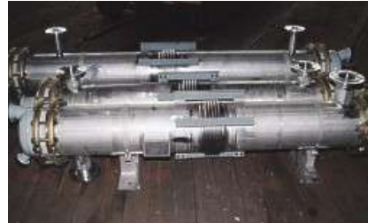
Rohrbündelwärmetauscher Werkstoff: Tantal 2,5% (Rohre, produktseitig) Edelstahl (Mantel) Hauben emailliert
