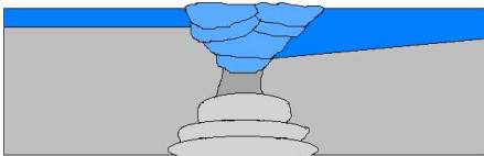
Linkes Bild: Schweißnahtaufbau mit geänderten Dickentoleranzen
